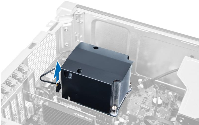
4. Afloje los tornillos que fijan al disipador de calor.
