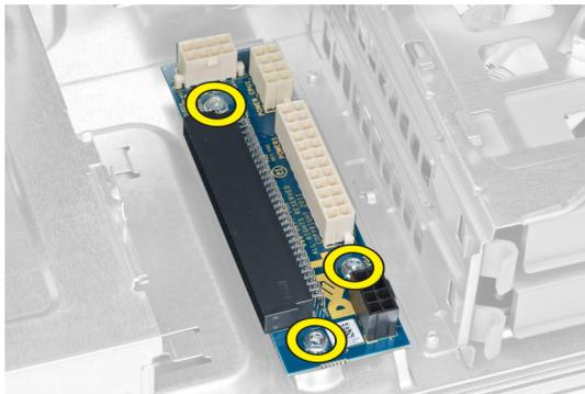
7. Extracción de la tarjeta PSU del equipo.
