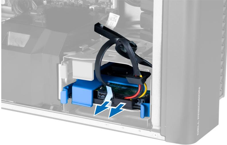
4. Presione en los pestillos al lado del soporte de la unidad de disco duro.
