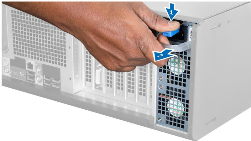
4. Sostenga el mango para deslizar el PSU fuera del equipo.
