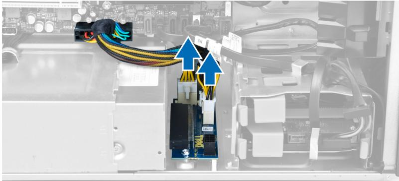
6. Extraiga los tornillos que fijan la tarjeta PSU a su ranura.
